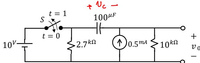
$$\begin{aligned} & \text{نحوه حملی کسر} \\ & v_C(0) = -5^v \end{aligned}$$
