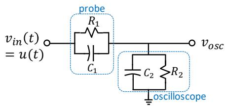
۴- شکل رو برو مدار معادل ورودی اسیلوسکوپ و پربو در وضعیت  $10 \times$  است.
