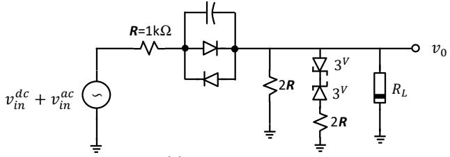
ب) با فرض  $v_{in}^{ac} = 20mV \sin \omega t$  و  $v_{in}^{dc} = 10V$  مقدار  $v_o$
